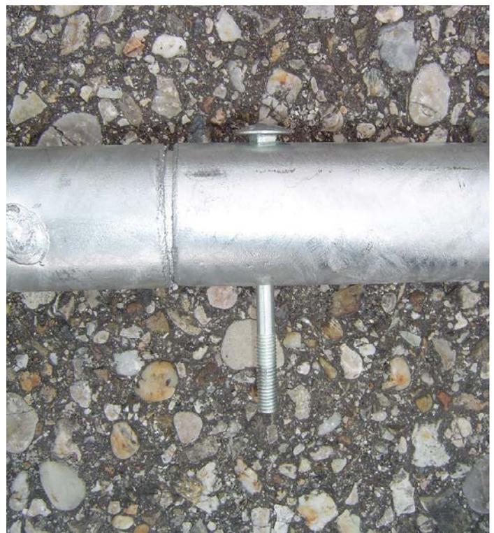
6. Verbinden Sie alle sonstigen Bögen mit den Verbindungsrohren (E2 – schwache Rohre mit verengtem Ende).
